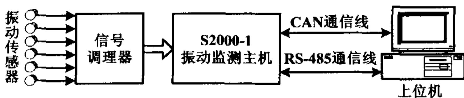
图 2 系统结构图 Fig. 2 System structure
