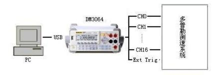
图 2. 引入 DM3064 的多普勒测速实验系统
