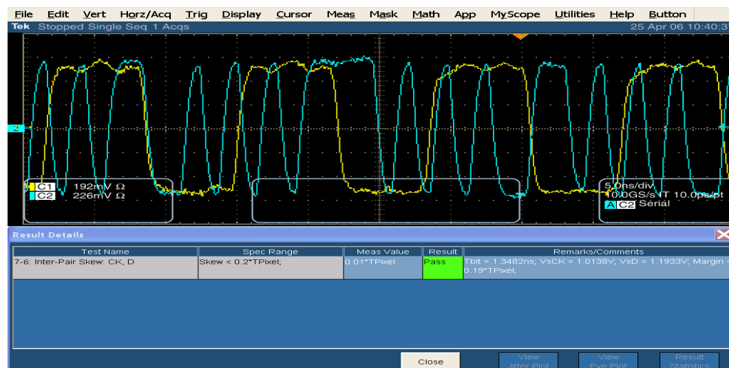
Figure 9 时钟-数据对间偏移测试
