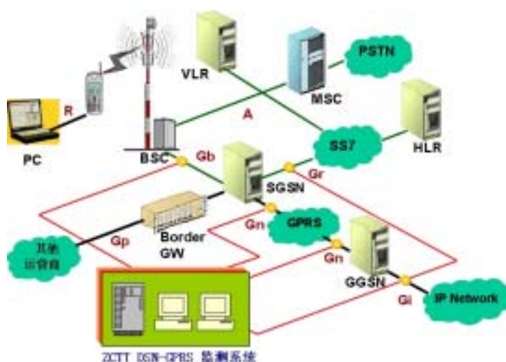
图 2 中创 DSN-GPRS 解决方案组网示意图
