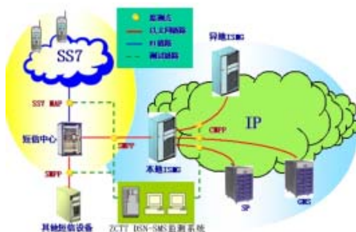
图 3 中创 DSN-SMS 解决方案组网示意图
